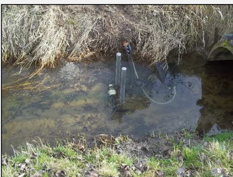
Abb.4: Sprühlanze zur Injektion des P- bindenden Fällmittels in die fließende Welle
