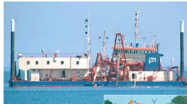
Seesand für den Boddendeich wird aus der Ostsee entnommen und lagert in einem bauzeitlichen Spülfeld
