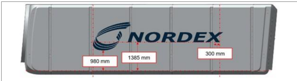
Abb. 5: Nordex-Logo auf der linken Seite eines Maschinenhauses ohne rote Tageskennzeichnung
