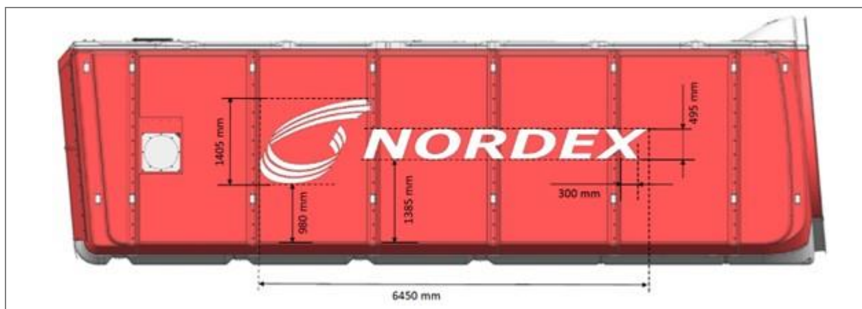
Abb. 8: Nordex-Logo auf der rechten Seite eines Maschinenhauses mit roter Tageskennzeichnung
