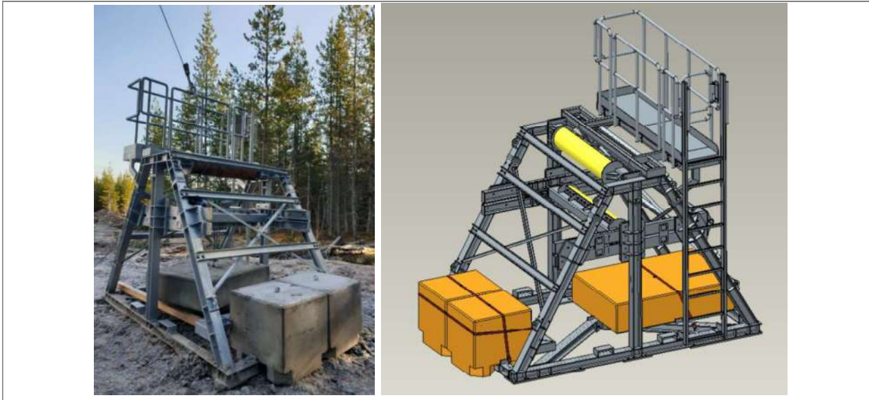
Abbildung 59 Darstellung eines Gestells für die Reibseilabspannung
